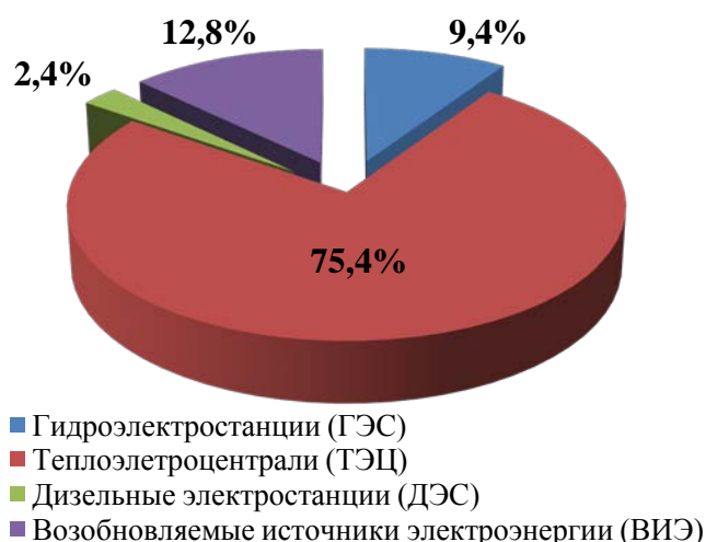
Рисунок 2.5.1 – Структура установленной мощности Центрального энергоузла энергосистемы Камчатского края по типам электростанций на 01.01.2021
